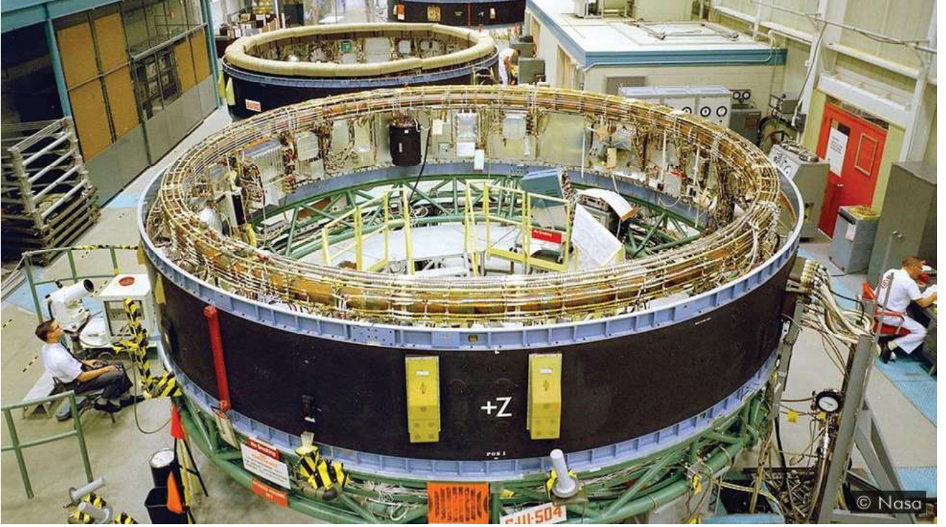
‘স্যাটার্ন ভি’র এই কমপিউটার ছিল এ পর্যন্ত কক্ষপথে সবচেয়ে উৎক্ষেপিত সবচেয়ে বড় কমপিউটার
