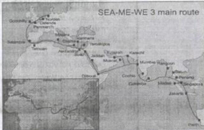
চিত্র ৪ : SEA-ME-WE 3 নেটওয়ার্কটি প্রায় ৩৮,০০০ কিলোমিটার জুড়ে জার্মানী থেকে যাত্রা করে আফ্রিকা, মধ্যপ্রাচ্য ও দক্ষিণ এশিয়া হয়ে সিঙ্গাপুর, অস্ট্রেলিয়া, কোরিয়া ও জাপান পর্যন্ত বিস্তৃত। এটির সাথেই টিএডটি বাংলাদেশকে যুক্ত করার পরিকল্পনা নিচ্ছে। পুরো নেটওয়ার্কে SDH প্রযুক্তি ও WDM (Wave Division Multiplexing) ব্যবহৃত হয়েছে। নিচের বা দিকের বক্সের ছবিটি কমপিউটার জগৎ নভেম্বর '৯২ সংখ্যায় প্রকাশিত 'FLAG' ফাইবার অপটিক নেটওয়ার্কের। ১৫ হাজার মাইল জুড়ে বিস্তৃত, বঙ্গোপসাগরের কিছু দূর দিয়ে যাওয়া এই ফাইবারের সাথে সূচনা হলোই আমাদের টেলিনেটওয়ার্কে সংযুক্তির কথা কমপিউটার জগৎ বলেছিল। সূত্র : এশিয়ান কমিউনিকেশনস
