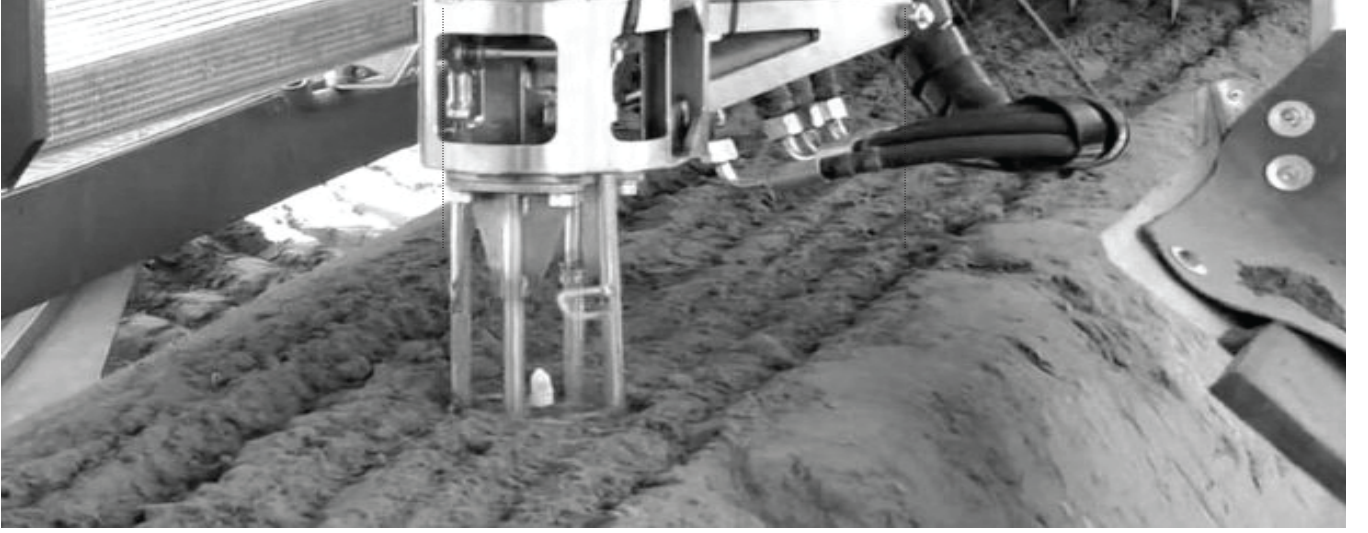
এই রোবট কৃষক শতমূলী গাছ চাষ করতে ও ফসল তুলতে পারে
