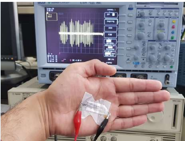
কামাল আসাদির ছাত্র পিজোইলেকট্রিক সুতার তৈরি কাপড়ের মেট্রি তার হাতের তালুতে রেখে তা সংযুক্ত করে দেন একটি যন্ত্রে। যন্ত্রটি ইলেকট্রিক চার্জ পরিমাপ করে। যখন এই ছাত্র তার হাত খুলেন ও বন্ধ করেন, তখন যন্ত্রটির স্ক্রিনে চার্জ প্রদর্শিত হয়। এতে বুঝা যায় বিদ্যুৎ উৎপাদিত হচ্ছে।
