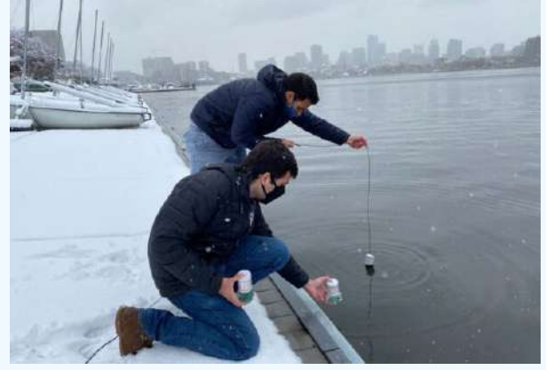
এমআইটির শিক্ষার্থী সৈয়দ সাদ আফজাল এবং ওসতি রডরিগুয়েজ বোস্টনের চার্লস নদীতে তাদের সেন্সরগুলো ডুবচ্ছেন। যখন শব্দতরঙ্গ এই সেন্সরগুলোতে আঘাত করে, তখন এগুলো কেঁপে ওঠে। পিজোইলেকট্রিক ম্যাটেরিয়াল এই কম্পনগতিকে বিদ্যুতে রূপান্তরিত করে। এ ধরনের সেন্সর ব্যবহার করা যাবে সমুদ্র পরিমাপের জন্য অথবা নেভিগেশনের কাজে
